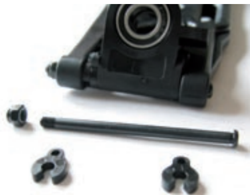
Altbewährtes hält auch beim X2 Einzug: Mit den kleinen Klipsen lässt sich noch ein wenig Spurlänge rauskitzeln
