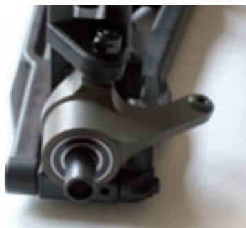
Die aus Aluminium gefrästen Lenkhebel sind ein sehr schönes Detail
